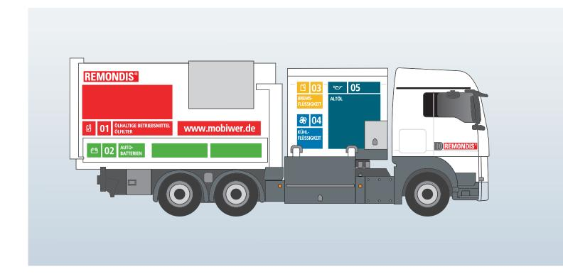
Spezialfahrzeug für die Komplettentsorgung von allen Werkstattabfällen
